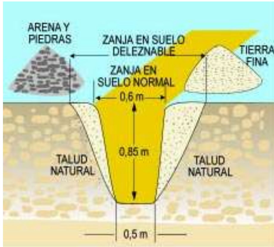
Perfiles de excavación de zanjas
