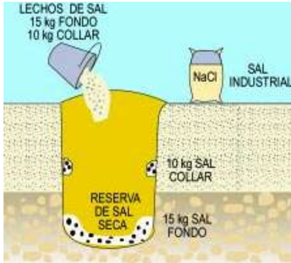
Lechos de sal en el fondo y collar del pozo
