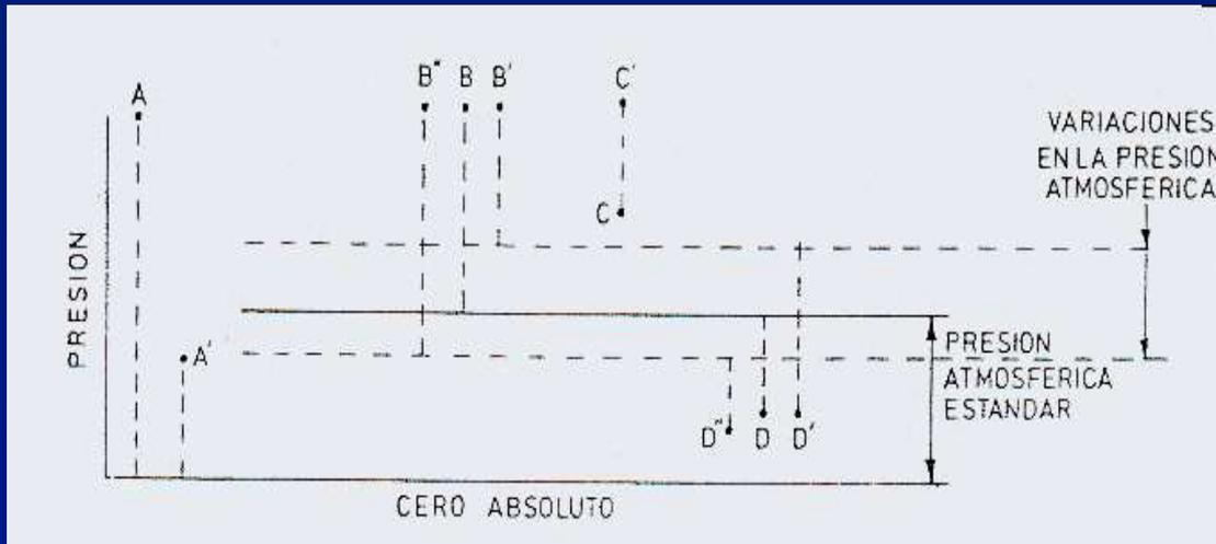
**La presión atmosférica** es la presión ejercida por la atmósfera terrestre medida mediante un barómetro. A nivel del mar, esta presión es próxima a 760 mm (29,9 pulgadas) de mercurio absolutas o 14,7 psia (libras por pulgada cuadrada absolutas) y estos valores definen la presión ejercida por la atmósfera estándar.
