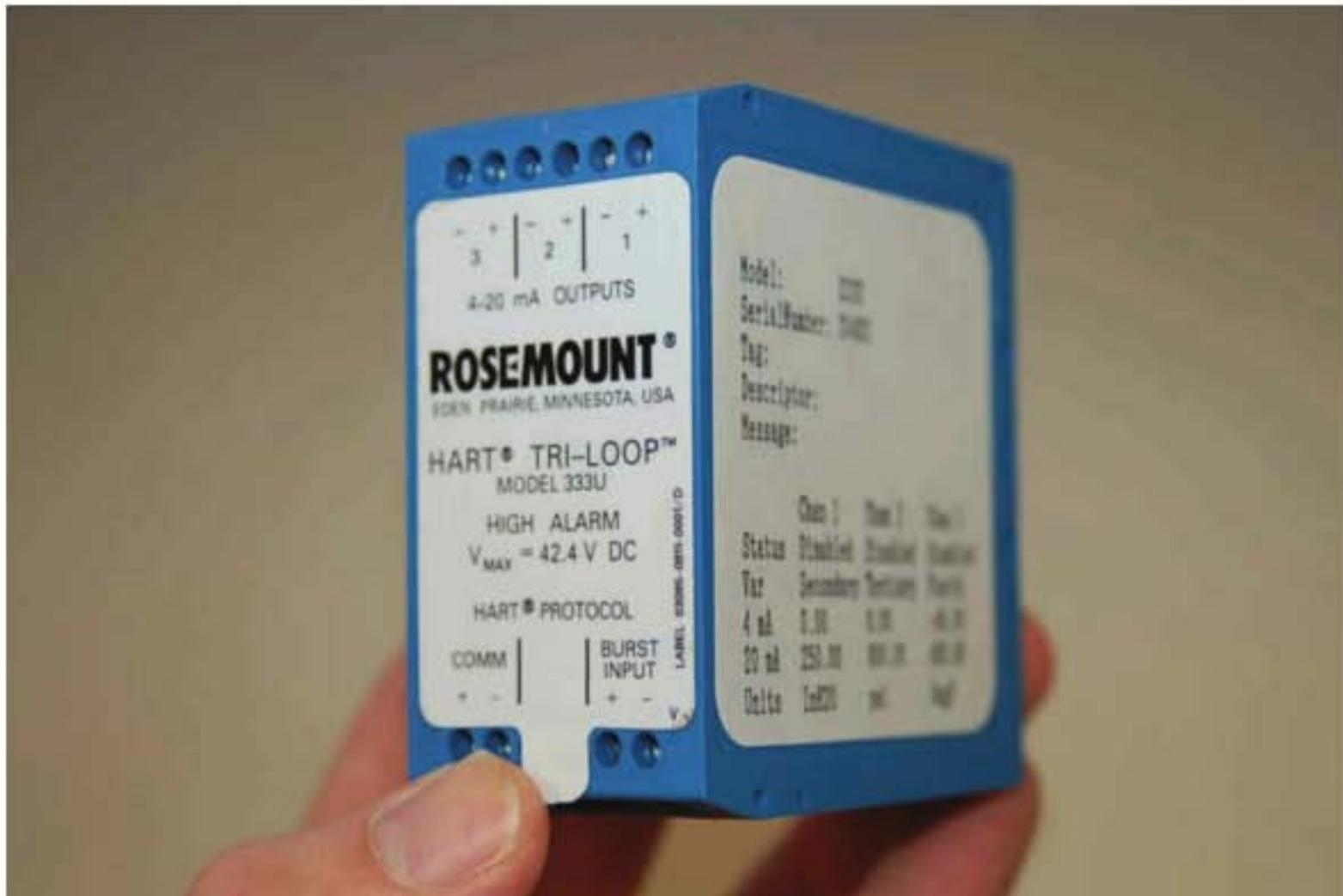
Este dispositivo interroga al transmisor multivariable y convierte las tres variables *HART* en señales de salida analógicas de 4-20 mA, las que son apropiadas para cualquier dispositivo controlador o indicador que las pueda recibir.
